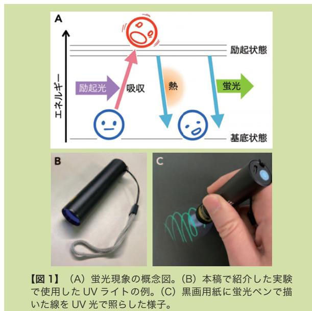
【図 1】 (A) 蛍光現象の概念図。(B) 本稿で紹介した実験で使用した UV ライトの例。(C) 黒画用紙に蛍光ペンで描いた線を UV 光で照らした様子。
