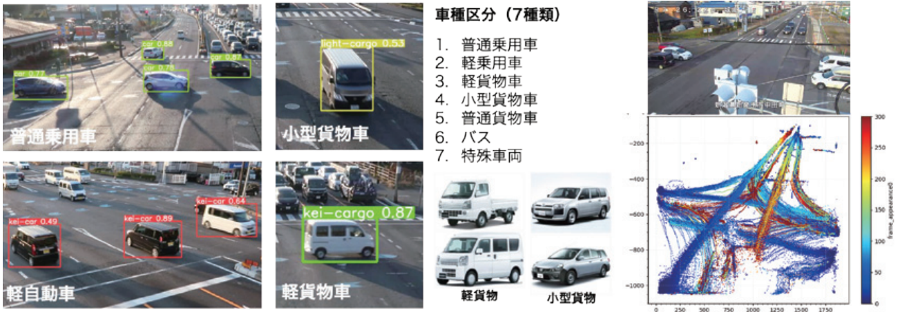
【図3】AIを活用した車種別交通量検出と車両移動軌跡の可視化
