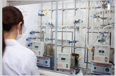
排気装置の中で配位高分子などの試料を合成する。窒素雰囲気下に置かれたフラスコ内の原料を、オイルバスとマグネチックスターラーで加熱攪拌している。
