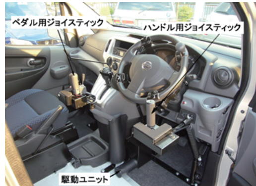
【図5】ジョイスティックシステムの車両搭載の様子
