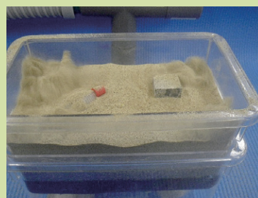
写真11 送気開始直後 送気量が一定以上に達すると砂層は急激に液状化し、たれビンは瞬時に浮き上がり、コンクリート片も徐々に沈んで行く
