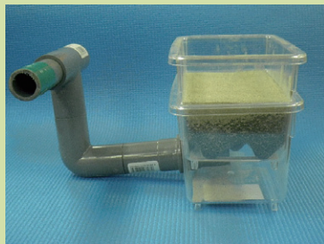
写真3 本装置の全体（横から） 二段に重ねた小型飼育ケースの下段には送気管が接続されている。上段のケースの底は取り除かれ多孔層（スポンジ）がはめ込まれ、その上に砂を置いて砂層とする。
