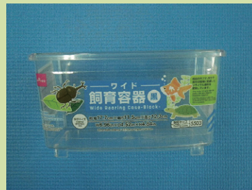
写真5 昆虫飼育ケース 蓄圧槽と多孔層の保持構造として使う飼育ケースは100円ショップで入手できる
