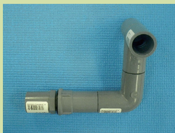
写真7 送気量調整器 水道配管用VP20塩化ビニール管のT字管・エルボー管・ソケットを適度な長さに切断した直管で接続する。強度はほとんど必要ないので接着は不要。差し込むだけ。
