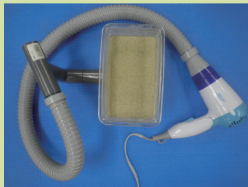
写真4 本装置の全体（上から） 家庭用ドライヤーの送風口に排水管の一端を固定し、他端は送気量調整器に差し込む
