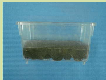
写真8 多孔層の装着 底抜け状態に加工した上段ケースの下部に梱包用などのスポンジを押し込む。ケースの内壁との間に隙間ができないように。
