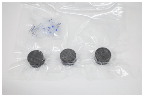
(写真2) 2,000℃～2,500℃の耐熱効果を探る、今年度の研究材料 (直径15 mm程度)
