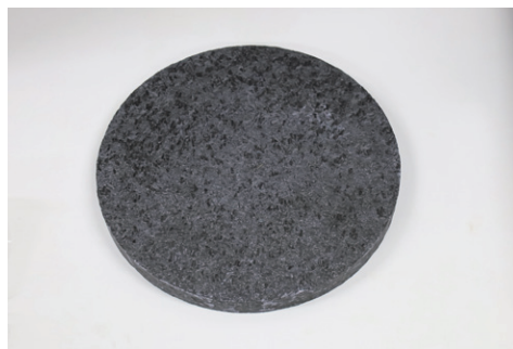
(写真1) ポルシェのディスクブレーキに使われるカーボンベースのセラミック複合材料 (直径270 mm程度)
