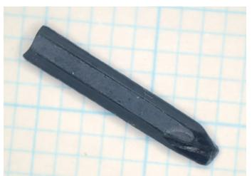
[写真左] 世界初の純正有機磁性体 $p\text{-NPN}$ Nの単結晶（1991年作成）
