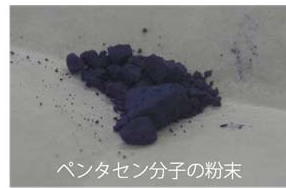
図2:ペンタセン分子の構造、および粉末試料の写真。ペンタセンは濃紺～紫色を呈する色素である。
