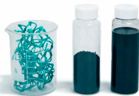
プラスチック製の漁網からつくったカーボンナノチューブ。
