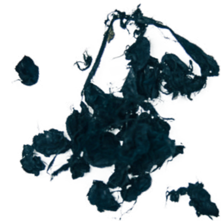
できたままのカーボンナノチューブ。 薄く伸ばしたりなどの加工が可能。
